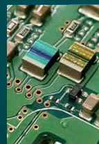
2ステップ目の飛躍に繋がる主要因となったフィルムコンデンサー。壊れやすい繊細な部品にもかかわらず、厳格な自社基準にかなうレベルにまで耐久性が上がり、ついに採用するに至っている。
