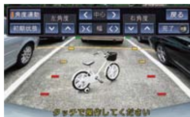
(弊社のカーナビゲーションでのガイドスケール表示調整画面を撮影したイメージです。)
