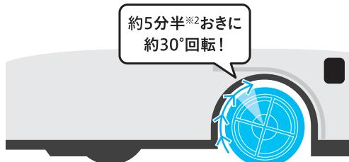
「回転式ローラー※1」を採用することで、走行中、約5分半※2おきに約30°ずつ最大11画面を替え、キレイな面で拭き掃除をします。
