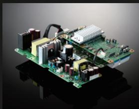
スピーカー部と独立した強固な専用シャーシに内蔵されたアンプブロックの内部は、大電力を扱う電源回路・高速信号を扱うデジタル信号処理回路・パワーアンプ回路の基板をそれぞれ独立。電源回路部はシールドすることで各ブロック間の不要な干渉を防ぎ、高S/N、高セパレーションを実現しています。さらに電源回路部においては、パワーアンプ回路、デジタル信号処理回路の相互干渉を低減するために、独立した各トランスから電源を供給する「Twin Power Supply Circuit System」を採用。各専用電源とパワーアンプ、デジタル信号処理回路を最短距離で、それぞれが離れた位置で接続できるように内部回路をレイアウトすることでローノイズ化を徹底しています。
