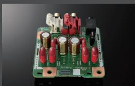
SC-CX700は、上位モデルで採用している部品を随所に搭載し、徹底して音質を磨き上げています。特にアナログ入力回路には上位モデルと同等の高品位なフィルムコンデンサーなどを惜しみなく採用し、妥協のない音質チューニングを行っています。
