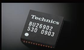
Technicsが誇る最新鋭のデジタルオーディオ技術を投入したフルデジタルアンプ「JENO Engine」を左右のスピーカーそれぞれに独立して搭載することで、ジッター成分の影響を抑え、左右の再生音の変質が生じない忠実度の高い信号伝送・増幅を実現しました。また、デジタルチャンネルデバイダーでウーハーとツイーター帯域を分割することで、パッシブネットワークレスで、スピーカーをダイレクトに駆動します。モノラルのマルチアンプ構成によって、デジタル音源の高解像度な音の再現を含め、アナログ音源の柔らかな感触も豊かに再生すると共に音源の持つサウンドステージを忠実に再現します。
