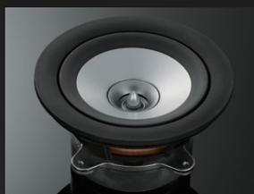
Technicsの点音源・リニアフェーズ思想に基づく同軸構造のスピーカーユニット「Phase Precision Driver 4」には新開発のリングツイーターを搭載。従来のドーム型と比較して振動系が軽量で音の立ち上がりと収束が素早く、不要な残響音が少ないことが特長です。このリングツイーターに波面解析に基づいて再設計した「Linear Phase Equalizer」を組み合わせ、ウーハー部には、浅型振動板とバツフル面までがスムーズにつながる形状とした「Smooth Flow Diaphragm」を採用。ツイーター、イコライザーからウーハー、バツフル面まで障害物のない滑らかな形状とすることで整った波面を形成し、上質なサウンドを実現しました。
