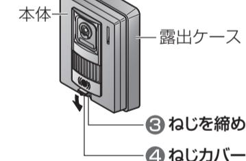
\*3 電動ドライバーなどを使う場合は、ねじの破損防止のため、締め付けトルクを0.7 N·m(7 kgf·cm)以下に設定してから固定してください。
