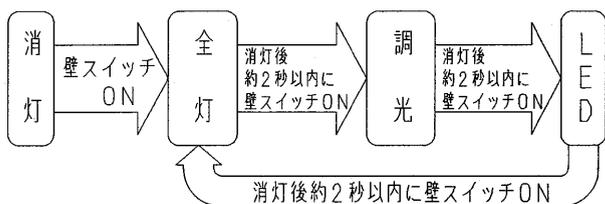
壁スイッチで消灯後2秒以上経過すると、再び壁スイッチをONさせた場合は消灯前の状態で点灯します。またリモコン送信器にて明るさを記憶させた場合、各点灯状態はその明るさで切り替わります。
