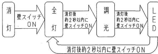
壁スイッチで消灯後2秒以上経過すると、再び壁スイッチをONさせた場合は消灯前の状態で点灯します。またリモコン送信器にて明るさを記憶させた場合、各点灯状態はその明るさで切り替わります。
