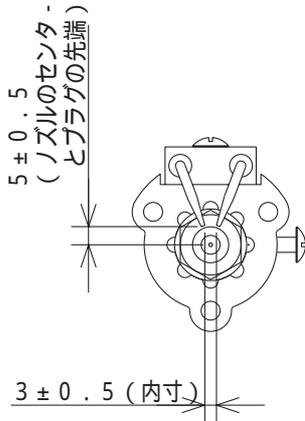
点火プラグは矢印の方向によせて固定する
