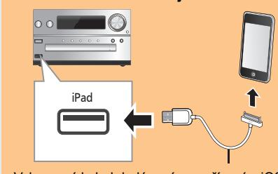
Vyhrazený kabel dodávaný se zařízením iOS
