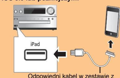
Odpowiedni kabel w zestawie z urządzeniem z systemem iOS
