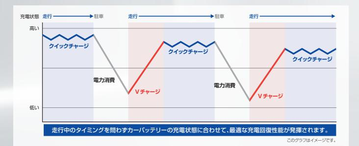
caos W1シリーズは、アイドリングストップ機能によるエンジン再始動などで電力を消費した状態から充電する「クイックチャージ」、駐車中にドライブレコーダーなどで電力を大量に消費した状態から充電する「Vチャージ」の、2種類の充電回復性能を備え、車が使用される条件にあわせて最適な充電を提供します。また、これらの充電を併用することで、アイドリングストップ寿命\*2をA3シリーズから1.5倍\*3向上させました。
