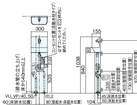
(注) アラウーノ手洗い コンパクトタイプは、手洗いボールを施工用パネルに引っ掛け施工する方式です。施工前には引っ掛けしろを50mm以上残してください。
