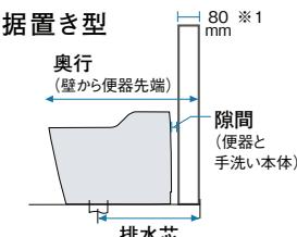
※1 本体キャビネットの奥行(収納扉は含まず)です。カウンター部の奥行は、据置き型102mm、フロート型167mm。
