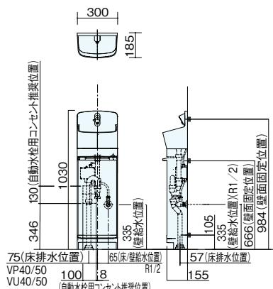
(注) アラウーノ手洗い ラウンドタイプは、手洗いボールを施工用パネルに引っ掛け施工する方式です。施工前には引っ掛けしろを50mm以上残してください。
