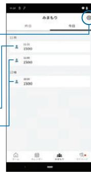
※3 着座と大洗浄・小洗浄を使用履歴として画面に表示します。
