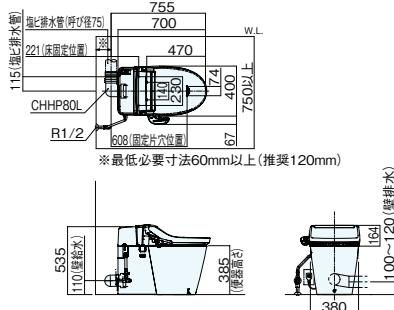
(注) 壁排水 155 で床給水の場合は長さ 90～130mm の給水管を別途手配してください。
