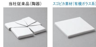
〈割れにくさの比較〉試験方法:重さ約200gの鋼球を40cmの高さから平板試験片に落下させる実験を実施。
