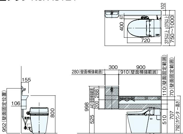
※手洗いボールの施工しろがボール上部に50mm 必要です（ボール取付時スライドさせるため）。
