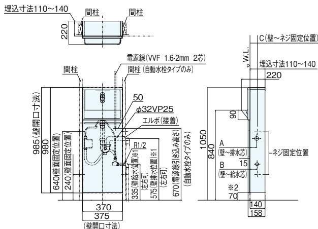
注) 自動水栓の場合、コントロールユニットは給排水管の取り出し側と反対の側板に取り付けてください。
