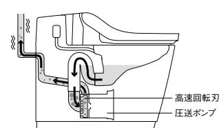
高速回転刃が汚物を粉碎し、圧力をかけて排水
