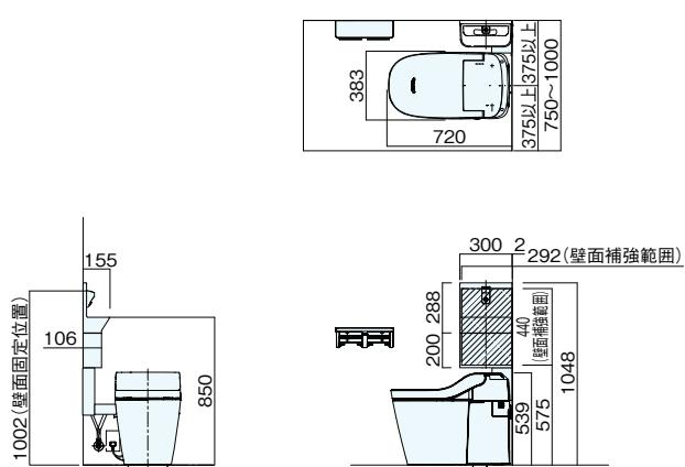
※手洗いボールの施工しろがボール上部に50mm 必要です（ボール取付時スライドさせるため）。
