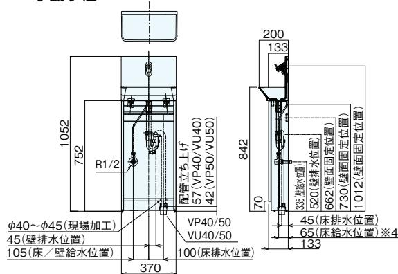
(注) 手動水栓は給排水位置を左右反転することが可能ですが。その場合、壁・床給水位置は向かって右側に105、壁排水位置は向かって左側に45、床排水位置は向かって左側に100としてください。(自動水栓は不可)
