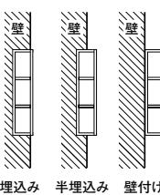
※1 壁面固定ネジで壁面に固定できれば、この寸法の限りではありません。（埋め込み収納商品には壁面固定ネジ用の下穴開口はありません。）電動ドライバーで取り付ける場合、電動ドライバーの直径+15mm程度の埋込寸法（約80mm）が必要です。
