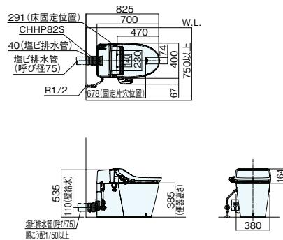
●壁排水 155で床給水の場合は、長さ 90～130mm の給水管を別途手配してください。
