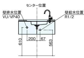
注)このプラン(フロート本体キャビネット)は手動単水栓・壁給水・壁排水のみ対応可能です。自動単水栓・混合水栓は取り付けできません。
