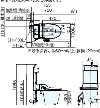
注) 壁排水 155 で床給水の場合は長さ 90～130mm の給水管を別途手配してください。
