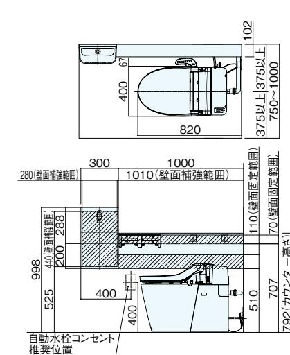
注)キャビネットタイプ・コーナータイプ・カウンタータイプは、手洗いボールを施工用パネルに引っ掛けで施工する方式です。施工前に引つけしろを50mm以上残してください。
