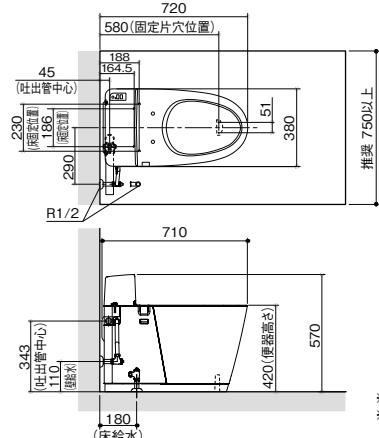
※床給水の場合は、長さ 90mm～130mm の給水管を別途手配してください。
