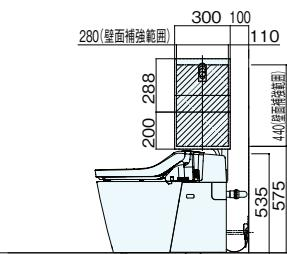
注)キャビネットタイプ・コーナータイプ・カウンタータイプは、手洗いボールを施工用パネルに引っ掛け施工する方式です。施工前には引っ掛けしろを50mm以上残してください。
