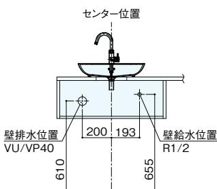
※このプラン(フロート本体キャビネット)は手動単水栓の壁給水・壁排水のみ対応可能です。自動単水栓・混合水栓は取り付けできません。
