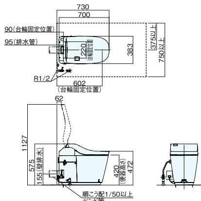
●壁排水 155で床給水の場合は、長さ 90～130mm の給水管を別途手配してください。
