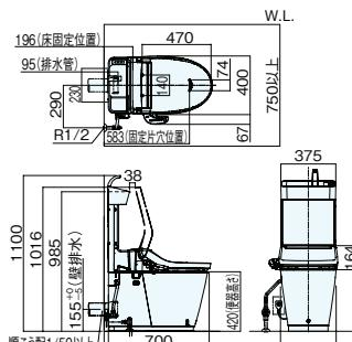
●壁排水 155 で床給水の場合は、長さ 90～130mm の給水管を別途手配してください。
