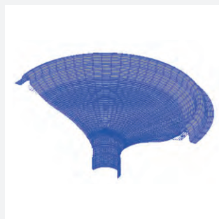
従来(当社)のコーン型振動板 コーン型振動板が分割振動を発生してうねるように変形
