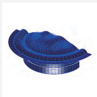
従来(当社)のドーム型振動板 振動板が分割振動を発生して凸凹に変形
