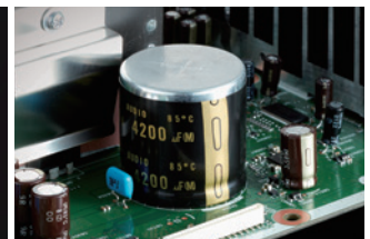
パワーアンプ用電源部のカスタムコンデンサー
