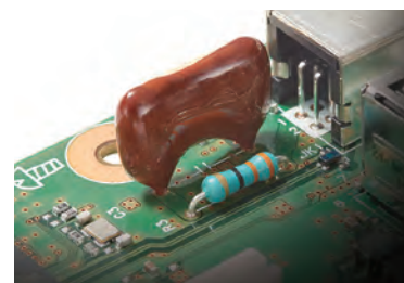
USB-B側のパワーコンディショナー PC側の電源ノイズを低減し、PCより低ノイズな信号を入力する。
