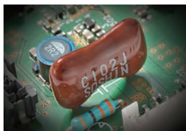
USB-A側のパワーコンディショナー USBメモリーなどUSB-Aから入力されるデバイスに低ノイズの電源を与えることにより、低ノイズな信号を得ることができる。
