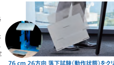
76 cm 26方向 落下試験(動作状態)をクリア
