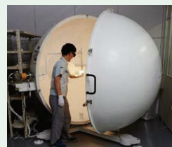
積分球(球面光束計)で LED電球の光の量と質を測定
