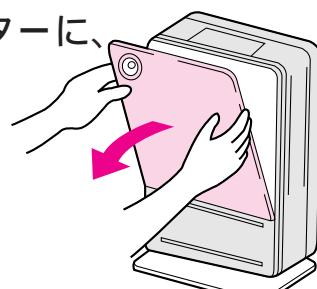
3 前面カバーにフィルターセットを固定する
