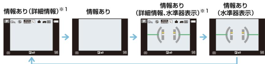
※1 カスタムメニューの[ヒストグラム表示]を[ON]に設定すると、ヒストグラムが表示されます。また、カスタムメニューの[露出メーター]を[ON]に設定すると、露出メーターを表示させることができます。(P56)
