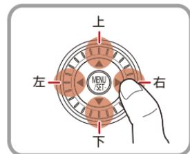
タッチパネル操作中でも、右図のようなガイドが画面に表示されているときは、カーソルボタンと [MENU/SET] ボタンでも操作することができます。
