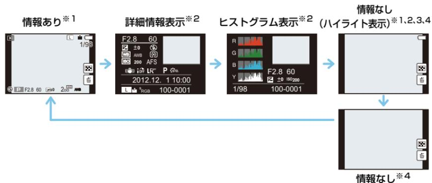
※1 約10秒以上何も操作しないと、画面上の情報が一部表示されなくなります。[DISP.]ボタンを押したり、モニターをタッチすると再度表示されます。
