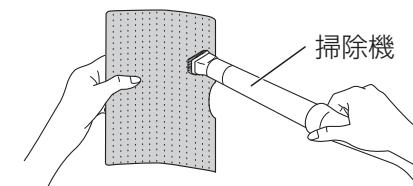
ほこり付着がひどくなると吸気フィルターランプが点灯し、運転が停止します。
