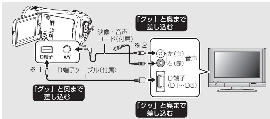
※ 1. D 端子は映像のみの出力になりますので、必ず映像・音声コードも一緒に接続してください。(D 端子入力の音声入力端子に差し込んでください。詳しくは、テレビの説明書をお読みください)
