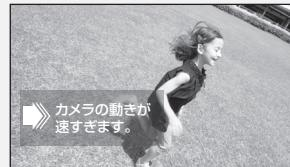
「カメラの動きが速すぎます。」と表示されたときは、本機をゆっくりと動かして撮影してください。
