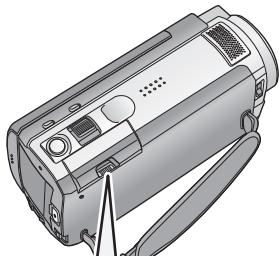
動作中ランプ点灯中に SD カードを抜くと、本機の誤動作や SD カード内のデータの破壊につながる恐れがあります。
