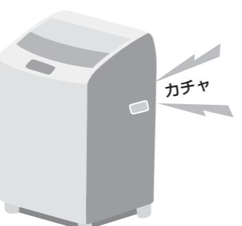
洗濯・脱水槽を揺らすと… ●チャブチャブ 脱水時のバランスをとるため槽内にある、液体の音(水が残っているわけではありません)
