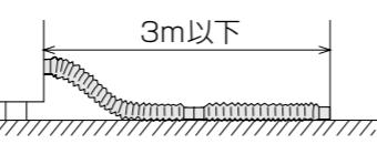
●先端部を直接、排水口に差し込む場合は、引っ張っても抜けないことを確認してください。
