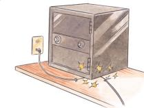
無理な折り曲げ、ねじり、束ね、引っ張り、加工、熱器具への接近、角のとがったものや重いものの下敷きなどは、電源コードの破損（芯線が見えているなど）となり、ショートや絶縁不良で発熱し、火災・感電につながります。
