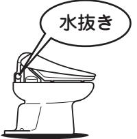
凍結すると、配管や本体内部が破損して水もれします。「水抜き」など、凍結予防をしてください。
