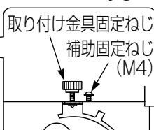
③プロジェクターを左へ回転させ、アタッチプレートの取り付け金具固定ねじで固定する。
