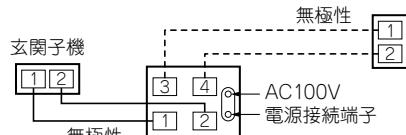
※呼出音増設用スピーカーを接続するときは、親機の接続端子 [3][4] に接続します。
