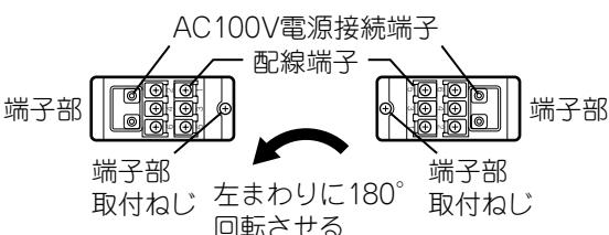
端子部取付ねじをはずし、端子部を左まわり180°回転させたあと、端子部取付ねじを取り付ける
