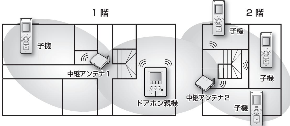
中継アンテナを設置する（増設）
