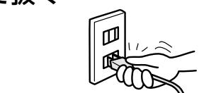
コードを引っ張ると、コードが破損し、感電・ショート・火災の原因になります。
