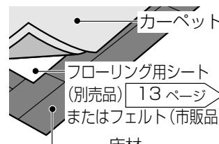
断熱をしないと、床材の変色・変形・割れ・すき間の原因になります。
