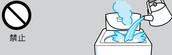
プラスチック部品の変形や傷みにより、感電や漏電の恐れがあります。
