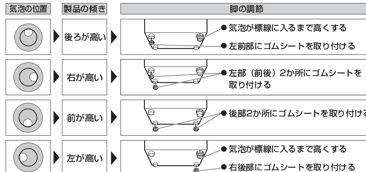
● 気泡の片寄りが斜めの場合：調節脚(右前部1か所)により、気泡の位置を上図のいずれかに近づけてから調節をしてください。
