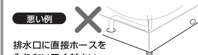
タンクがつり構造になっているため、脱水時の振動で排水ホースが外れたり、破れたりすることがあります。
