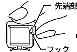
クランパーの上部を指で押さえながら、先端部を手前に引いて、フックを外します。
