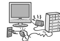
傷つけたり、加工したり、重いものをのせたり、加熱したり、熱器具に近づけたり、無理に曲げたり、ねじったり、引っぱったりすると芯線の露出、ショート、断線により火災・感電の原因となります。
