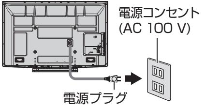
●すべての接続完了後に、電源プラグを差し込む。
