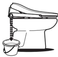
→水抜きをしてから電源プラグを抜いてください。
