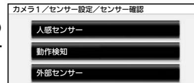
カメラ側がセンサー検知待ち状態になり、現在のカメラ映像が表示される
