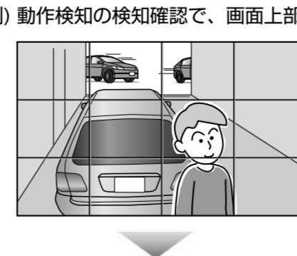
動作検知範囲の設定画面で、検知させたくない車道のエリアを選ぶ
