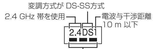
2.4 GHz 帯を使用 電波と干渉距離
