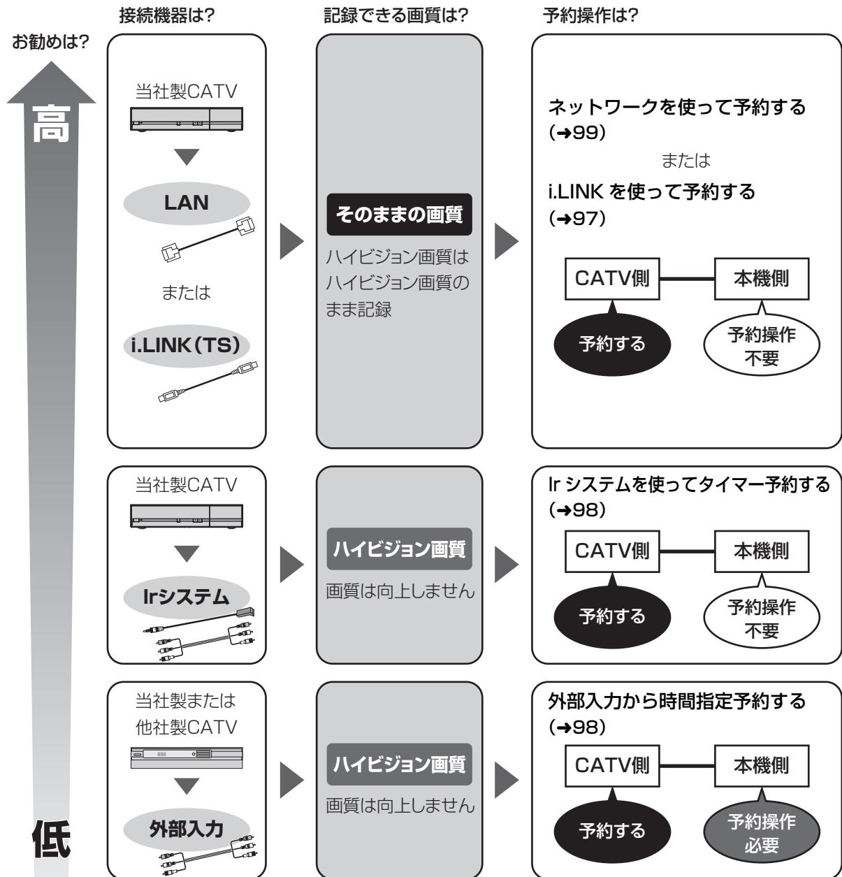
i.LINK (TS) 端子や Ir システムを使っての録画は、当社製 CATV セットトップボックスでの動作のみ保証しています。他社製品と接続する場合は外部入力を使って録画してください。
