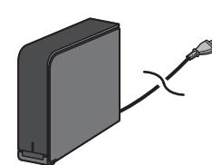
電源供給方式の USB-HDD の場合、本機で使用中は電源を切ったり、電源コードを抜いたりしないでください。
