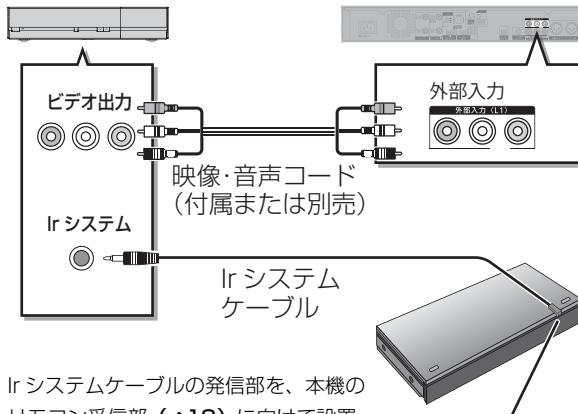
Irシステムケーブルの発信部を、本機のリモコン受信部(→18)に向けて設置
