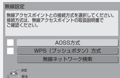
無線ブロードバンドルーター（アクセスポイント）がAOSS™やWPS (Wi-Fi Protected Setup™)に対応している場合は、「AOSS方式」または「WPS (プッシュボタン) 方式」を選び、簡単に設定することができます。
