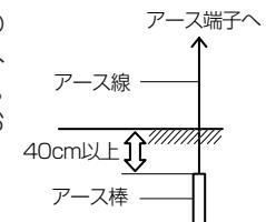
次の場所には、アース工事（D種接地工事）が法律で義務付けられています。
