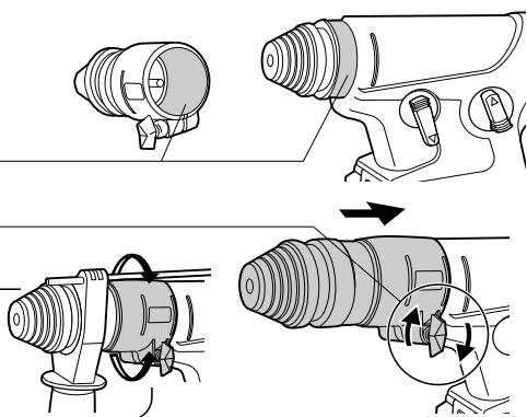
※アタッチメントは蝶ネジをしっかりと締めた状態でも360°回転できますので、作業状況に合わせて調整してください。
