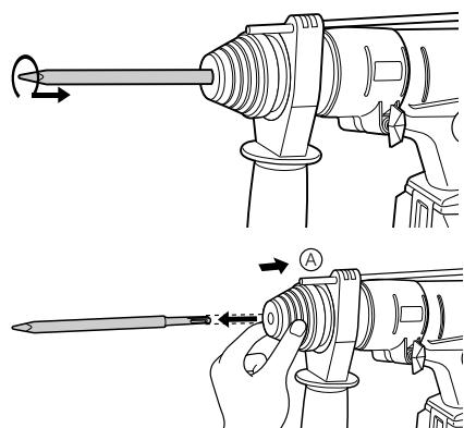
**【取りはずし方】** はつりビットはチャックをⒶ方向へスライドさせて引き抜くと取り外せます。
