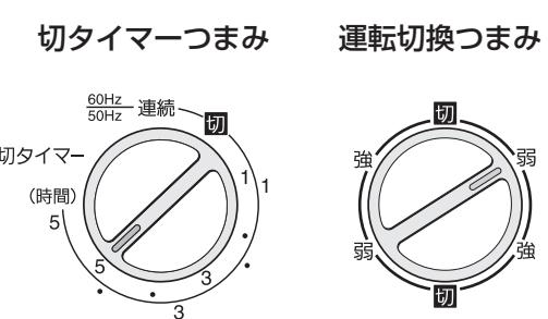
(イラスト中の切タイマーは、50 Hzでは、5時間、60 Hzでは4時間を表しています)
