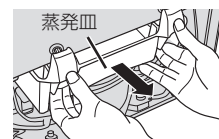
蒸発皿は両手で持ち静かに引き抜くと外れます。
