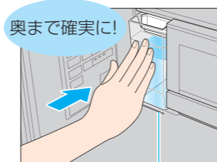
奥まで確実に! 線が見えるまで、確実に押し込む
