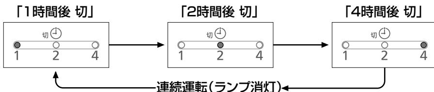
設定例 「2時間後 切」を設定 ▶ 2時間後に運転が停止
