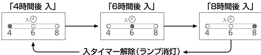
**設定例** 「4時間後 入」を設定 ▶ 運転が「停止」 ▶ ボタンを押したときから4時間後に運転が再開
