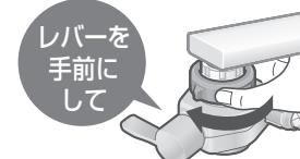
②ナットを動かないように押さえ、水切換レバーを正面にねじる
