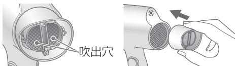
速乾ノズルは吹出穴が縦方向になるように吹出口にそえて、「カチッ」と音がするまで強く押し込む。
