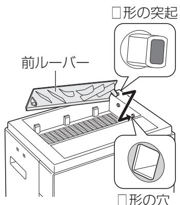
2 ルーバーを回して左側の穴の向きに合わせ、中央部を少し曲げて、左側も差し込む
