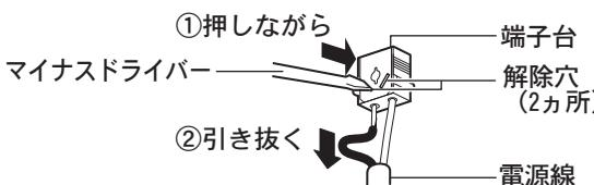
マイナスドライバー等の先端で解除穴を押しながら片方ずつ電源線を引き抜く
