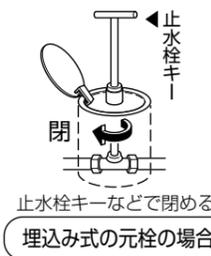
止水栓キーなどで閉める埋込み式の元栓の場合
