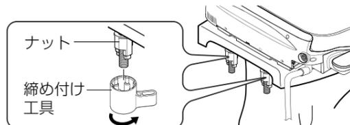
(取付ボルトが長すぎる場合は金のコなどで適当な長さに切断する)
