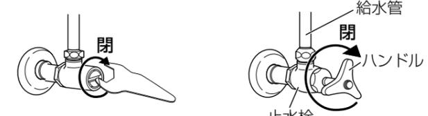
止水栓を閉側に止まるまで回した後、ロータンクのレバーを回し水を流しきってください。
