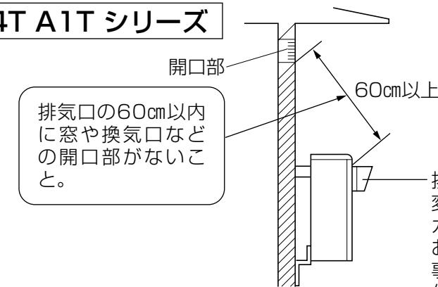
排気ガスの噴出し方向を上方に変えたい場合には、別販の排気カバー(品番OB-KT1TZ)をお買い求めのうえ、同様の工事説明書に従って排気口に取り付けてください。
