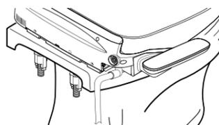
(取付ボルトが長すぎるときは金のごなどで適当な長さに切断する)
