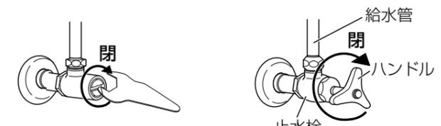
止水栓を閉側に止まるまで回した後、ロータンクのレバーを回し水を流しきってください。
