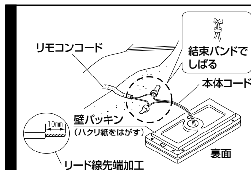
▶▶ 図3 リモコン本体の壁面への固定のしかた
